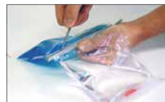
1.- Retirar la barrera entre los dos componentes
